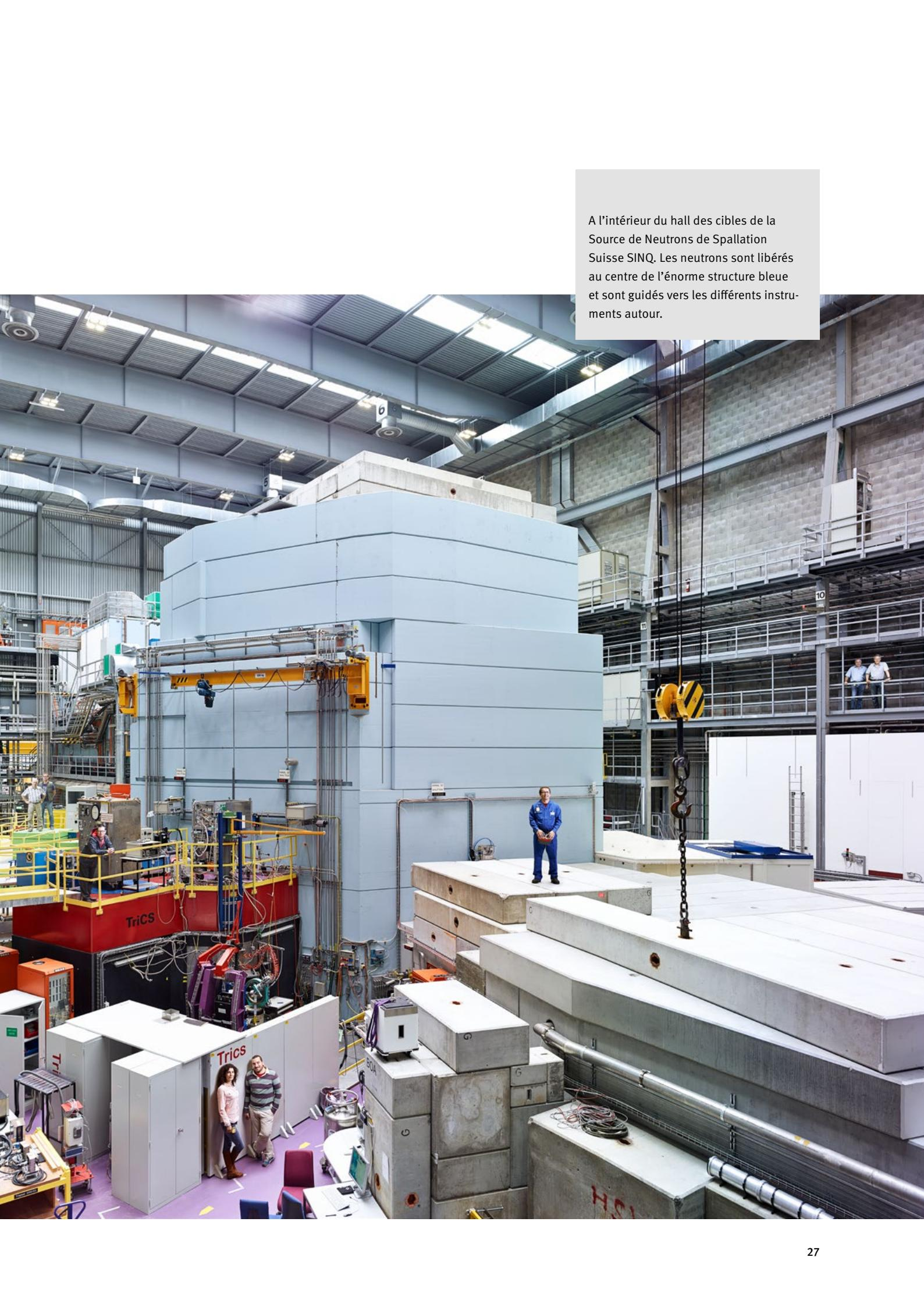
A l'intérieur du hall des cibles de la Source de Neutrons de Spallation Suisse SINQ. Les neutrons sont libérés au centre de l'énorme structure bleue et sont guidés vers les différents instruments autour.
